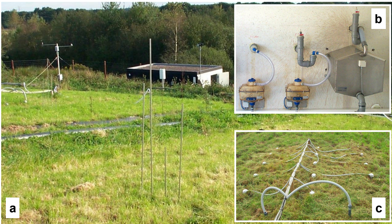
Abb. 2: Versuchsfelder auf der Altdeponie Kuhstedt; a : Versuchsfelder mit Wetterstation und Messcontainer sowie Gasmesssonden (vorne) für die Untersuchungen zur Methanoxidation; b : Darstellung einer Kippzählereinheit; c : Sonden für bodenhydrologische Messungen
